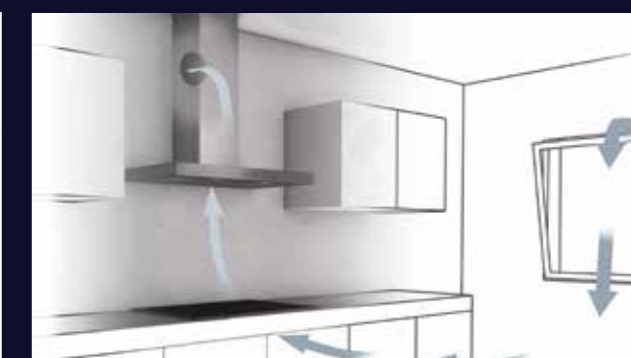
Aspirazione ad espulsione
